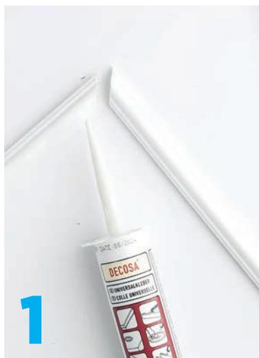
**1** Dans un premier temps, collez les quatre baguettes de même longueur avec la colle universelle. Laissez bien sécher la colle avant de passer à l'étape suivante.
