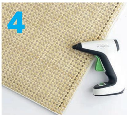
**4** Pour fixer le treillis viennois au dos du cadre, appliquez un peu de colle chaude sur les baguettes à l'aide d'un pistolet à colle, puis appuyez fort sur le treillis.
